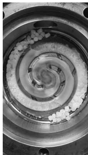
図2 フラットスクリューの 可塑化過程
