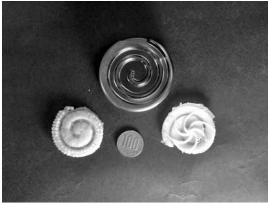
図1 ディスクスクリューにおける樹脂の挙動
