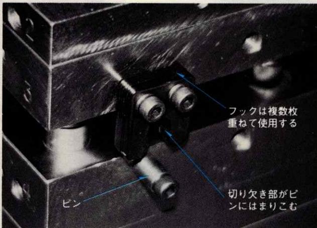
図1 ●金型の開き順序が簡単に決定できるフック
