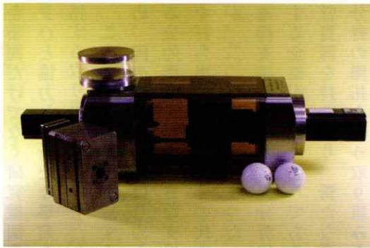
従来の常識を覆す小型化に成功したモバイル射出成形機
