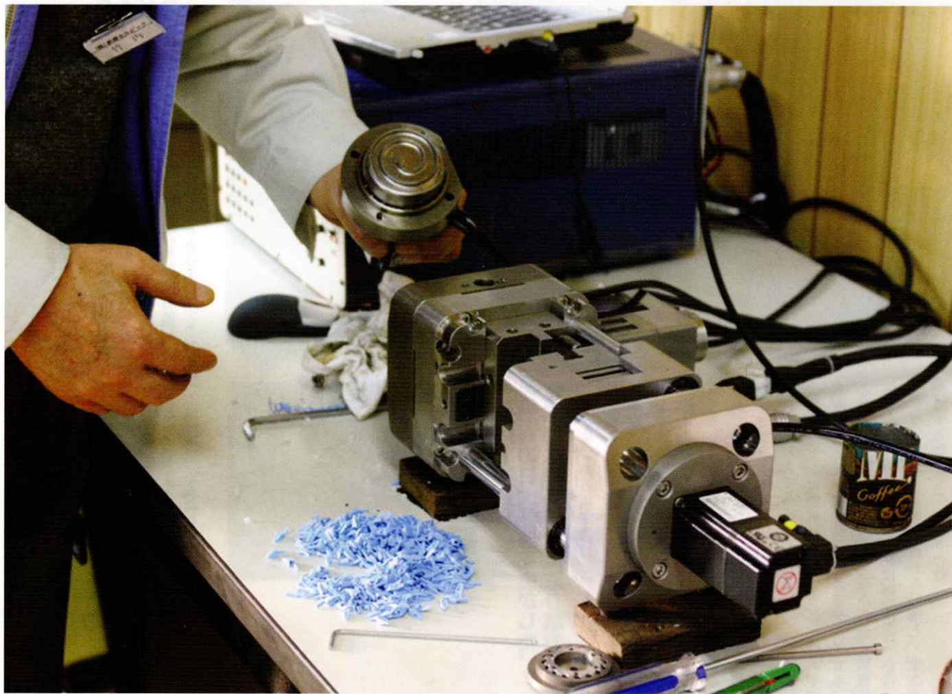
本体サイズは、高さ12cm×幅29cm×奥行12cm。一見して、これが射出成形機とは信じられない
