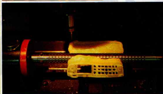
新興セルビックのプラスチック部品自動製造装置はまさにロボットの卵だ。樹脂成形装置でおおよその形をつくり(左)、切削して完成品にする(右下)。竹内宏社長(右上)は、「よい技術は常に単純」と語る
