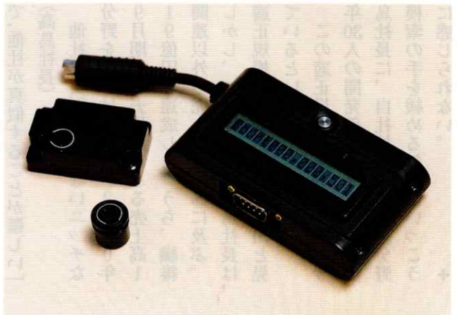
同社が開発したカウンターを取り付けることで、既存の金型製品情報の入力が可能となる。さらにパソコンをつなげれば、ネット上で製品情報をやりとりできる
