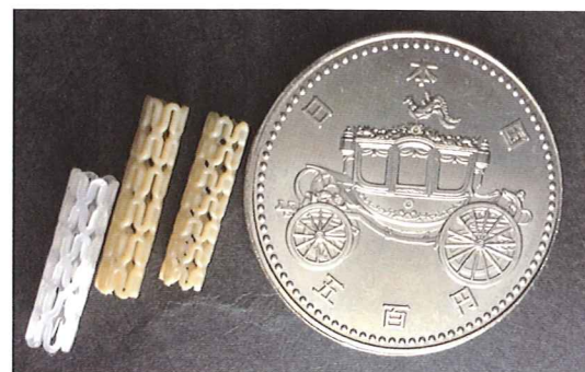
心血管用の比較的に太いステント。白いのがPLA(PGA)。褐色のものがPEEK。
