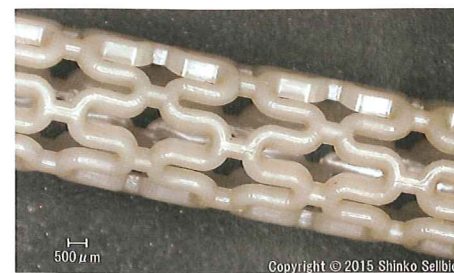
ポリエーテルエーテルケトン(PEEK)製の量産射出成形ステント(拡大写真)
