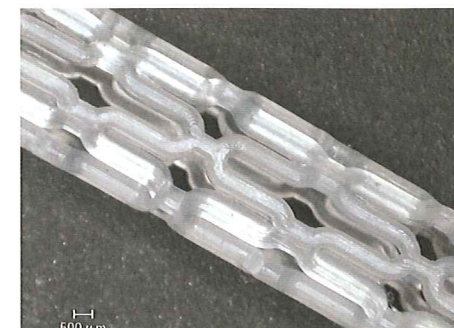
ポリ乳酸(PL)系材料のPGAを使った射出成形ステント(拡大写真)
