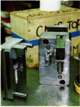
開発第1号のユニット金型。型の部分だけ交換できる画期的な製品。
