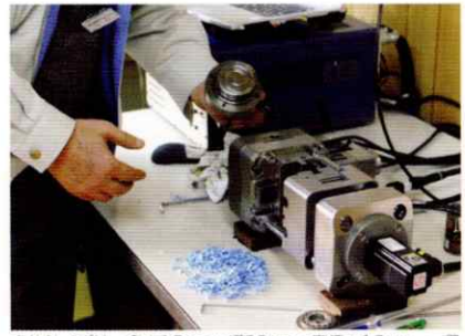
本体サイズは、高さ12cm×幅29cm×奥行き12cm。一見して、これが射出成形機とは信じられない
