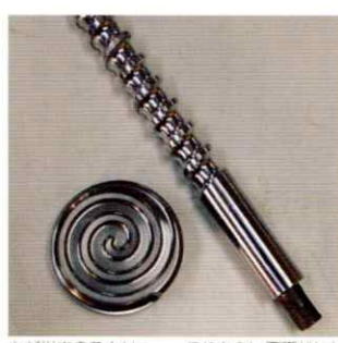
右が従来のスクリュー。これを丸い平面状にしたことで、一気に小型短縮・高能力化に成功
