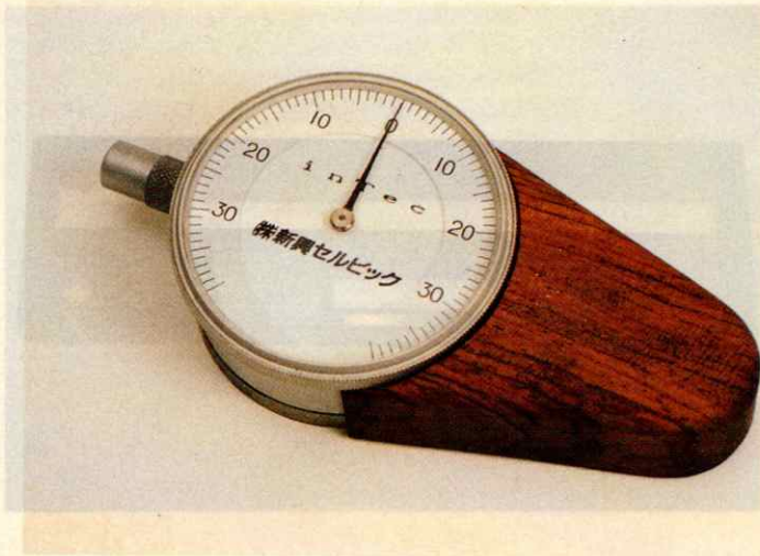
【図2】パーティングラインゲージの外観と仕組み。表示部とスピンドルの裏にネオジウム磁石が仕込んである
